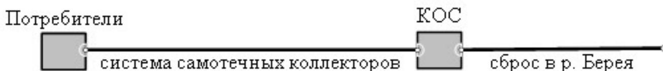
**Рис. 1. Принципиальная схема системы централизованного водоотведения п. Магистральный**
