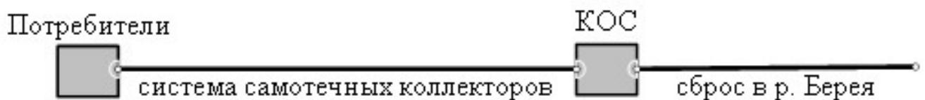
**Рис. 1. Принципиальная схема системы централизованного водоотведения п. Магистральный**
